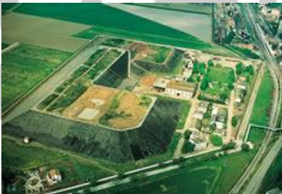
Recubrimiento de las instalaciones de producción y las escombreras de concentrados de uranio.
